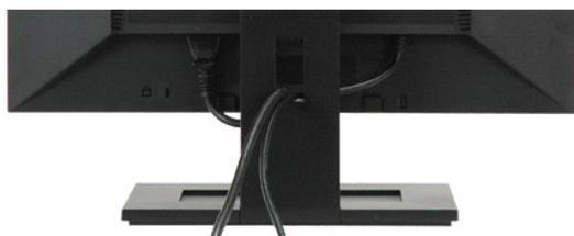
Dopo aver fissato tutti i cavi al monitor e al computer, (Vedere [Collegamento del Monitor](#)) usare il passacavi per organizzare i cavi in maniera ordinata, come mostrato sopra.
